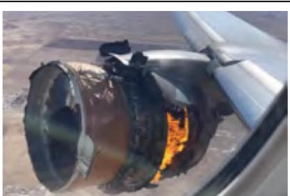
Fabricante admite: “fadiga de metal” das hélices do motor pode estar provocando os acidentes
